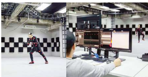
The One Academy 动作捕捉工作室备有 Sony PlayStation 最先进的动作捕捉设施，装有 32 台 VICON 摄像机及实时显示屏，可实时捕捉身体动作和面部表情。这技术广泛应用于电影、动画和电玩游戏开发行业。
